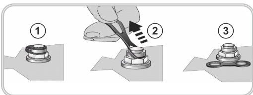
Şekil 3: Havalandırma Tapasının Devreye Sokulması
