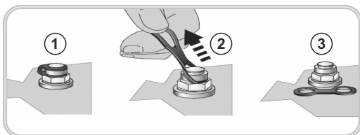
Şekil 3: Havalandırma Tapasının Devreye Sokulması
