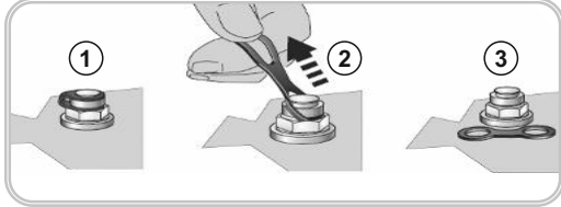
Şekil 4: Havalandırma Tapasının Devreye Sokulması
