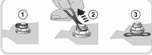
Şekil 3: Havalandırma Tapasının Devreye Sokulması
