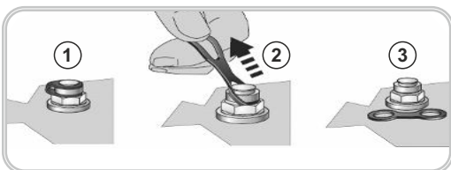
Şekil 6: Havalandırma Tapasının Devreye Sokulması
