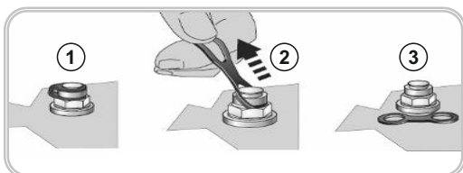
Abbildung 3: Aktivierung des Entlüftungsstopfen
