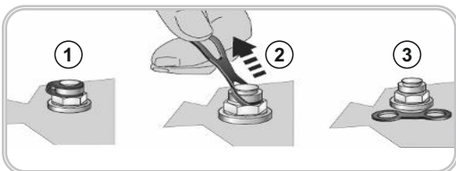
Şekil 3: Havalandırma Tapasının Devreye Sokulması
