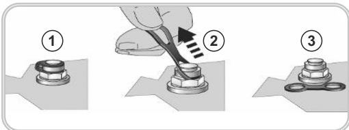
Şekil 3: Havalandırma Tapasının Devreye Sokulması
