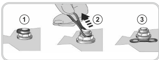
Şekil 3: Havalandırma Tapasının Devreye Sokulması
